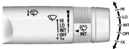
La palanca del limpiaparabrisas/lavador está en el lado derecho de la columna de dirección. Con la ignición encendida o en ACC/ACCESSORY (accesorios), mueva la palanca del limpiaparabrisas para seleccionar la velocidad del limpiador.
