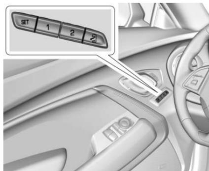
Si está equipado, los asientos de memoria permiten que dos conductores guarden y recuperen sus posiciones de asiento únicas para conducir el vehículo, y una posición compartida de salida para salir del vehículo. También se pueden ajustar otras posiciones de función, tales como los espejos eléctricos. Las posiciones de memoria están enlazadas al transmisor RKE 1 o 2 para recuperaciones de memoria automáticas.
