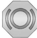
El tapón del depósito del líquido de frenos/embrague hidráulico tiene este símbolo. Vea en *Vista general del compartimiento del motor* ⇨ 289 la ubicación del depósito.
