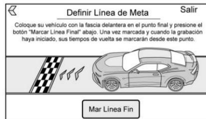
Para establecer la línea final, coloque el vehículo con la defensa delantera en el punto de inicio / final. Desde el menú PDR, toque Defina Línea de Meta y luego toque Mar Línea Fin. Esto se puede hacer con el vehículo en movimiento.
