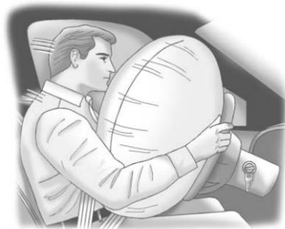
La bolsa de aire frontal del conductor está en el centro del volante de conducción.
