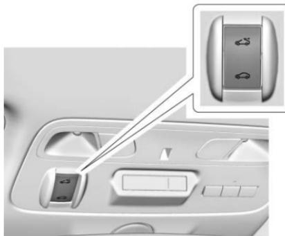
Si está equipado, el quemacocos sólo funciona cuando la ignición se encuentra encendida o en ACC/ACCESSORY (accesorios), o cuando la Energía retenida para los accesorios (RAP) está activa. Consulte *Energía retenida para los accesorios (RAP)* ⇨ 244.
