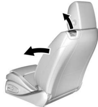
Para tener acceso a los asientos traseros, jale del seguro en la parte superior del respaldo del conductor o del pasajero delantero. Doble el respaldo hacia adelante.
