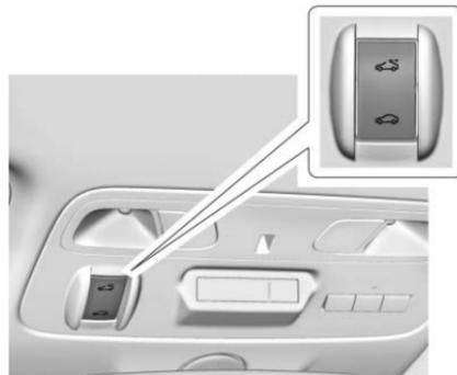
Si está equipado, el quemacocos sólo funciona cuando la ignición está encendida o en ACC/ACCESSORY (accesorios), o en Energía retenida para los accesorios (RAP). Vea *Energía retenida para los accesorios (RAP)* ⇨ 244.
