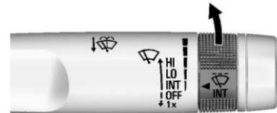
**INT** : Mueva la palanca hacia arriba hasta INT para pasadas intermitentes, luego gire la banda
