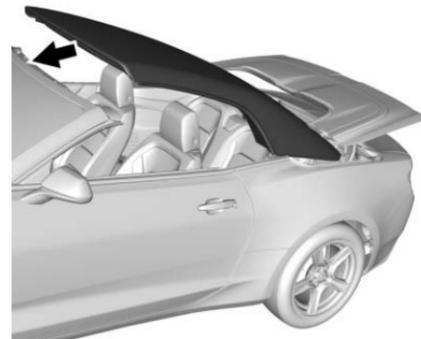
2. Levante y mueva el toldo convertible hacia adelante jalándolo de ambos lados del arco delantero hacia la posición totalmente cerrada.
