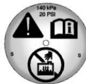
1. Retire el tapón de presión del tanque de compensación del refrigerante de la cámara superior cuando el sistema de enfriamiento, incluyendo el tapón de presión del tanque de compensación del refrigerante y la manguera superior del radiador, ya no están calientes.
