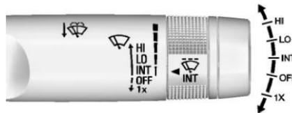
La palanca del limpiaparabrisas/lavador está en el lado derecho de la columna de dirección. Con la ignición encendida o en ACC/
